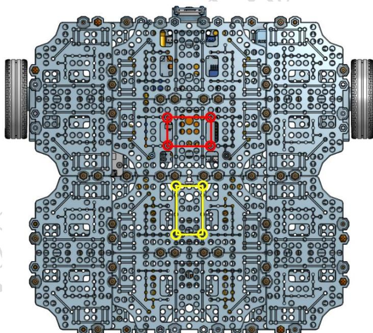
其中红色位置为激光雷达的安装孔，黄色位置为机械臂的安装孔。安装好后的整体结构如下图所示。
