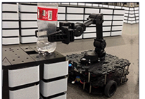
移动抓取操作 通过粒子滤波机械臂与移动底座结合，使机械臂在操作过程中不受底座移动限制能更大范围进行抓取任务。
