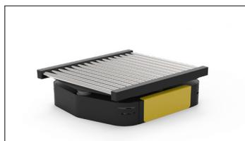
D[VWWSU] 非常适合原型工厂应用。前后激光安装座可提供 90° 度覆盖, 以确保安全, 而板上 I ;8; 可提供与设施基础设施的连接。
