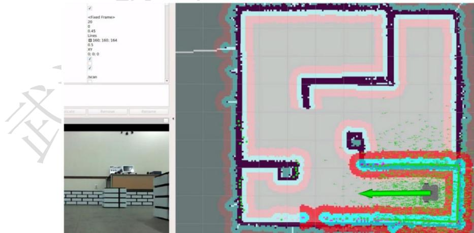
[Remote PC]一切准备就绪后，让我们尝试通过导航 GUI 进行 move 命令。如果按 2D Nav GoalRViz 菜单中的，则会出现一个非常大的绿色箭头。该绿色箭头是可以指定机器人目的地的标记。箭头的根是机器人的 x 和 y 位置，箭头所指的 theta 方向是机器人的方向。在机器人将要移动的位置单击此箭头，然后将其拖动以设置方向，如下所示。TurtleBot3 发送目标位置：
